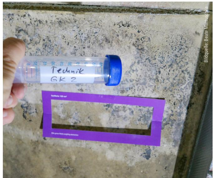
Abb. 10: Technikraum, Wischprobe W2-TE
