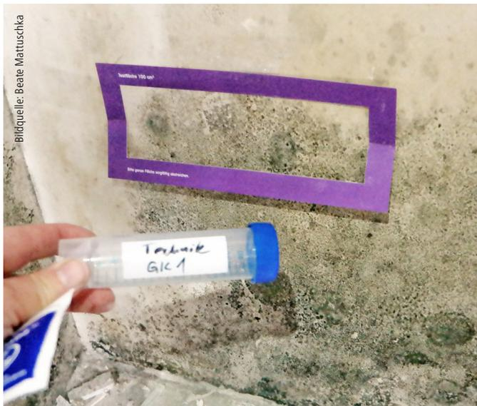
Abb. 9: Technikraum, Wischprobe W1-TE
